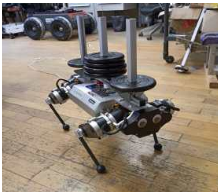
Рис. 26. Робот во время испытаний на грузоподъемность.
