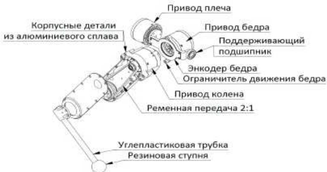
Рис. 4. Основные узлы ноги робота.
